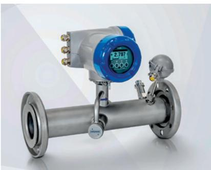
Krohne a réactualisé son débitmètre à ultrasons Optisonic 7300 pour la mesure de biogaz (pur) sec et humide de composition variable. En plus de la sonde de température standard, il est désormais équipé d'un capteur de pression qui est disponible en option avec le débitmètre et est fourni monté sur le tube de mesure. Associé au calculateur de débit intégré, le capteur additionnel fournit une mesure avancée du biogaz.
