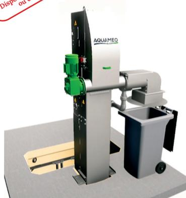
Le dégrilleur vertical compacteur DVC est entièrement automatique. Il est utilisé pour la séparation des liquides et des solides dans la phase de prétraitement des stations de traitement des eaux usées et des stations de pompage. Le compacteur intégré permet un traitement immédiat des déchets relevés par le dégrilleur: réduction du volume et transfert automatique des déchets vers un container.
