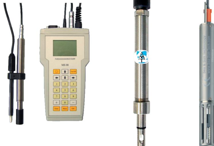
Plusieurs intégration du micro capteur H2 sont possibles fonction de l'application, sur un instrument portable tout en un, en pointe d'une sonde support avec sortie analogique ou dans un système multi-paramètres pour les mesures en profondeur.
