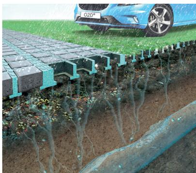
Les systèmes de sols perméables carrossables O2D® répondent aux enjeux de l'urbanisme durable. Le concept O2D® est fondé sur un système de sol « ouvert », perméable à l'eau et à l'air, avec pour objectifs de **préserver les fonctions naturelles du sol et favoriser l'infiltration des eaux pluviales à leur point de chute**, sans ruissellement.
