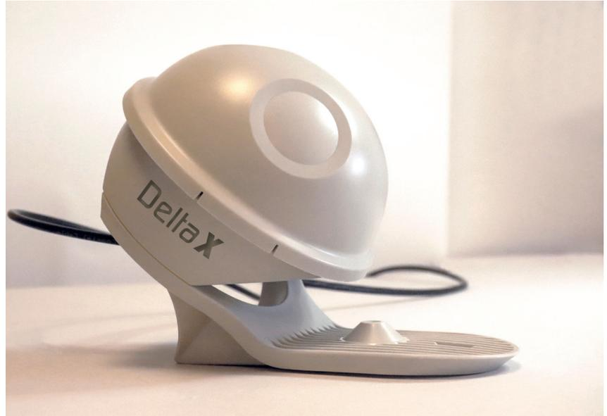
connecter des compteurs, poires de niveaux ou des contacts de défauts. Ses 2 entrées ANA 4-20 mA permettent de gérer des capteurs de niveau, pression, PH ou température par exemple. Le DeltaX fournit aux capteurs une alimentation 12V régulée et contrôlée dans le temps pour optimiser l'énergie.
