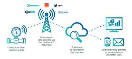
La technologie appelée G3 est compatible avec plusieurs fabricants de compteurs (Itron, Diehl Metering, Honeywell, Arad) et plusieurs protocoles de communication radio (LoRaWan, Sigfox, Homerider) afin de s'adapter à la variété des besoins des collectivités.
