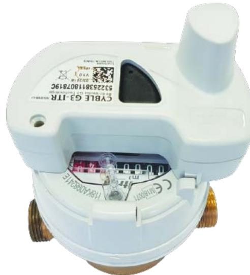
compatible avec plusieurs fabricants de compteurs et plusieurs protocoles de communication radio, permettant de répondre à une grande variété de besoins. Deux protocoles de communication sont notamment disponibles pour s'adapter aux besoins spécifiques des territoires : le protocole LoRaWAN et le protocole Homerider.
