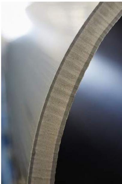
Plan de coupe d'un tuyau PVC CR8 Sotralys fabriqué par Dyka.
