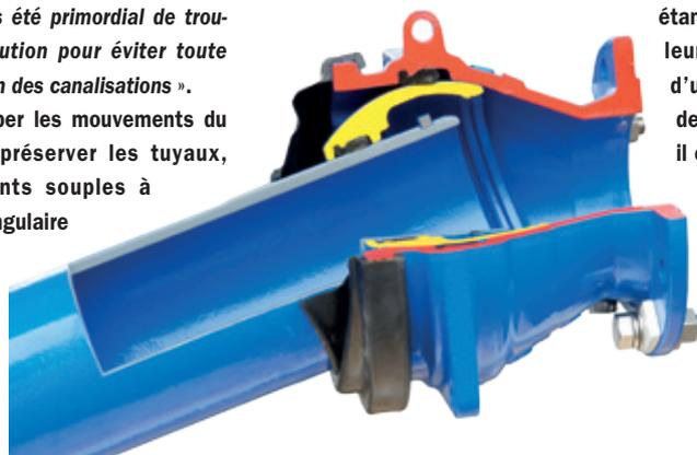
Les tuyaux conservent ainsi leurs caractéristiques, les mouvements étant assurés par les raccords en entrée et sortie. Constitué d'un manchon coulissant et de deux rotules à brides articulées, Géoflex® est assemblé sans boulon et ne présente donc pas de risque de casse du dispositif.
