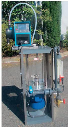
Ce réacteur compact utilise un mélangeur dynamique à fort gradient de vitesse pour inverser l'émulsion de polymère.
