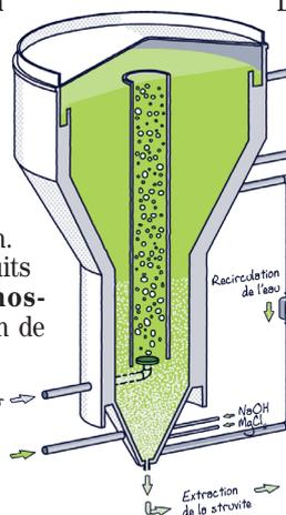
La struvite est ensuite extraite par le fond du réacteur puis lavée, égouttée et séchée avant d'être conditionnée.
