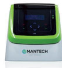
Le nouveau COT-mètre **Aurora 1080** utilise une combustion catalytique à **680°C**. Grâce à ses technologies brevetées, vous pourrez mesurer :
