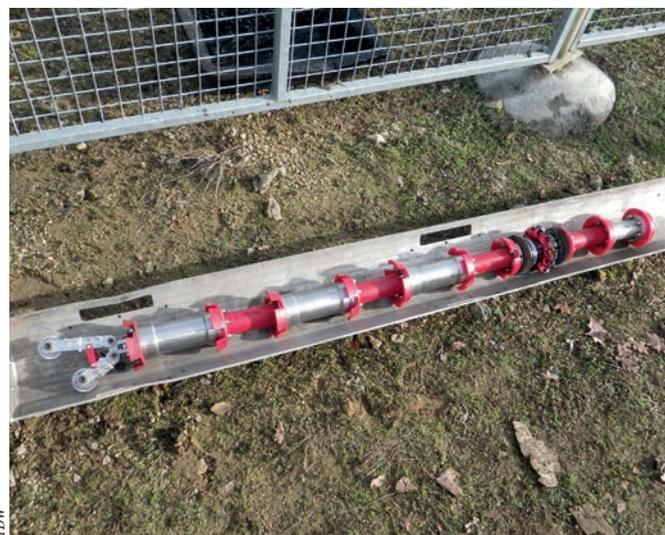
**Vue du racleur instrumenté MFL (Magnetic Flux Leakage).**
