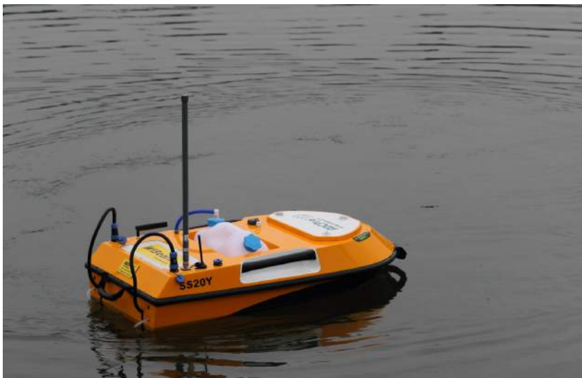
Drone radiocommandé Wiboat MIP pour prélèvements d'échantillons dans les plans d'eau et les cours d'eau tels que lacs et rivières (longueur 1,05 m, poids 18,9 kg). Équipé de propulseurs Waterjet à expulsion.
