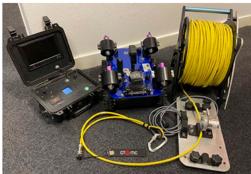
D'un poids de 15 kg, le robot siphon développé par CT2MC pour Sèche Assainissement est capable d'évoluer en forte pente, passer les colonnes et évoluer en roulant directement au fond du siphon.
