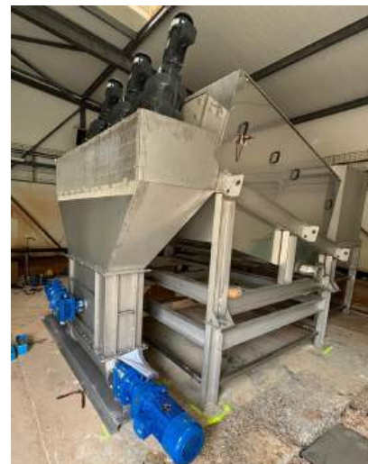
Atlantique Industrie - Déshydratation des boues industrielles d'une sucrerie en Normandie avec une presse à vis Ec'Eau Press MDS 453 inox 316 ; capacité 500 kg de MS/h - Siccité >20%.
