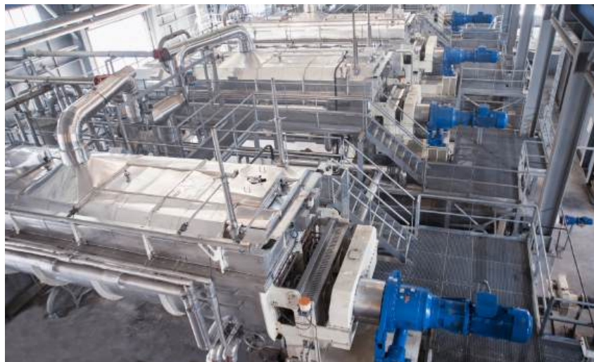
Sècheurs à pales Andritz Gouda - Modèles similaires à ceux installés à la station d'épuration de Jebel Ali à Dubaï pour produire des biosolides destinés à être utilisés comme engrais et amendement du sol.
