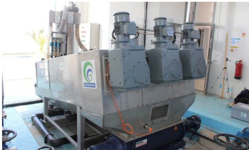
Unité de déshydratation des boues Adequapress® délivrant 180 kg MS/h avec un taux de capture de 98.5%
