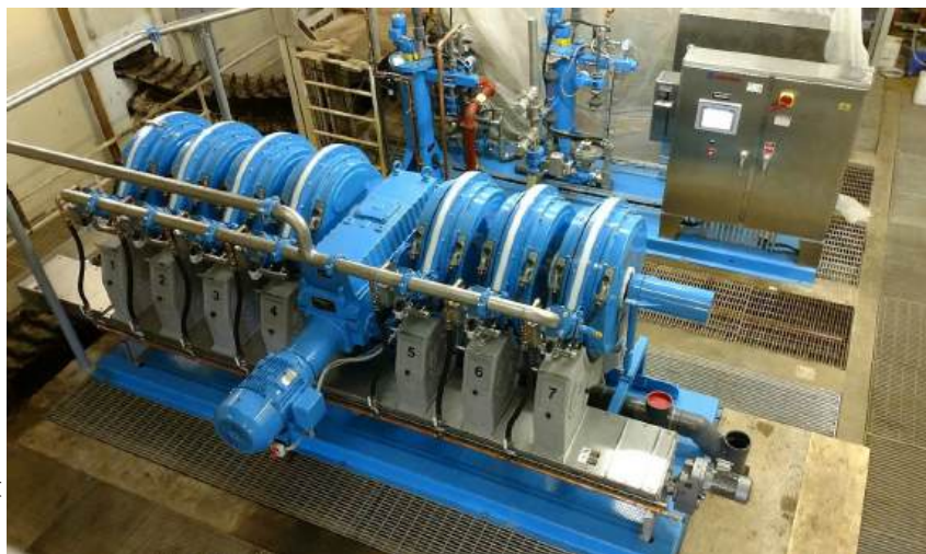
Rotary Presse Faure Equipements 6 canaux installé dans une papeterie.
