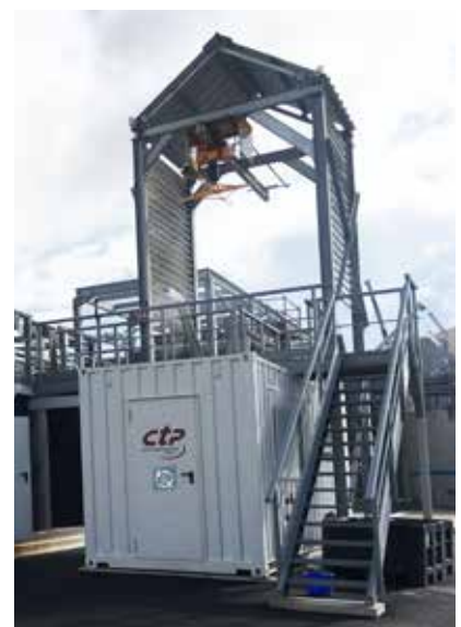
RE-Source by CTP environnement group: pilote de traitement des eaux usées avant réutilisation.
