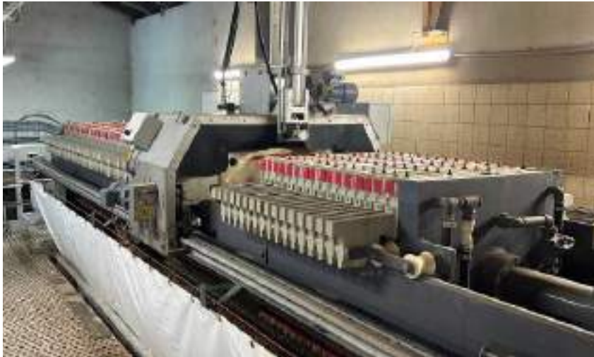
Filter-press Titan Full Auto de Faure Equipements sur une STEP de 25 000 Eh.
