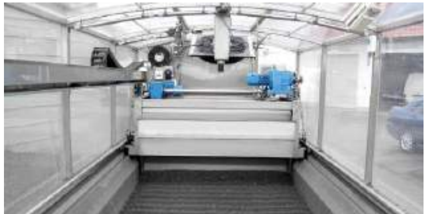
Le Baby Solstice® Huber permet la démonstration in-situ de la capacité de séchage de la boue, afin notamment de consolider le bilan de rentabilité sur des applications industrielles.
