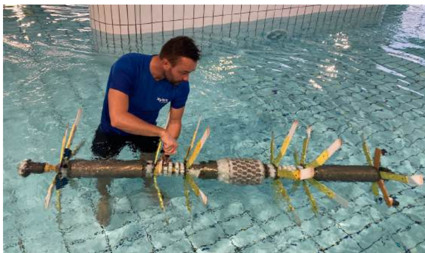
Le PipeDiver de Xylem va permettre d'analyser la structure des canalisations de gros diamètre pour évaluer leur taux d'usure, intérieur et extérieur, et ainsi déterminer leur durée de vie.
