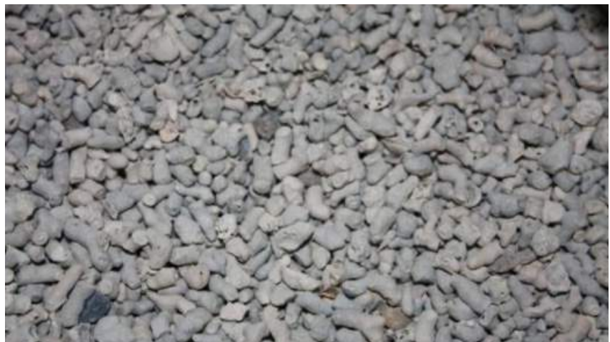
Figure 30. filtration sur maërl breton (calcaire marin). Traitement de neutralisation des eaux agressives
