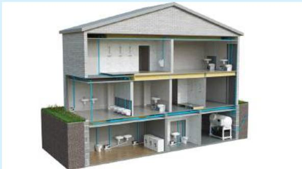
Ces dernières années, Evac a vu une nouvelle tendance s'amorcer avec une installation dans les bâtiments pour répondre aux contraintes qu'un réseau en gravitaire classique représente dans les projets de rénovation avec changement d'usage.
