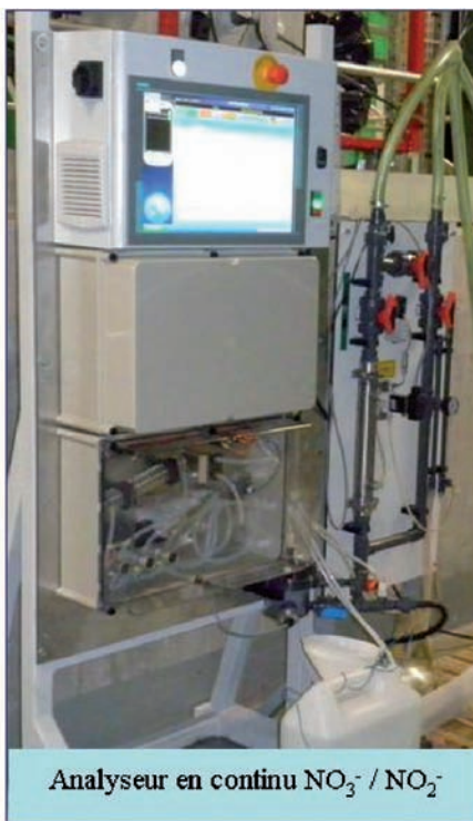
Figure 3 : dispositifs de prélèvement et de mesure déployés dans le cadre de ce projet.
