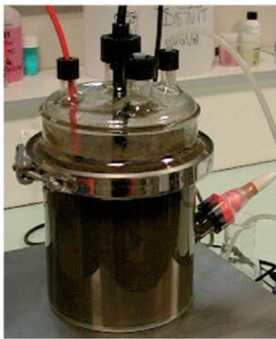
Figure 1 : Montage expérimental mis en œuvre pour étudier l'influence de la source de carbone sur le processus de dénitrification biologique.
