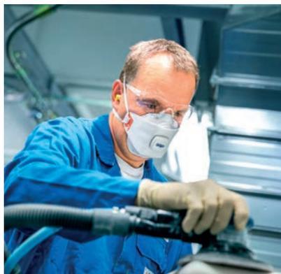
Le nouveau Dräger X-plore 1900 est un demi-masque à usage unique haute performance avec filtration anti-particules qui sert de protection contre les poussières fines et les particules.
