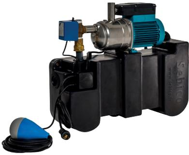
Le Pack'eau Box est un gestionnaire d'eau de pluie autonome qui gère la mise à disposition de l'eau sur son installation domestique pour des usages non potables. Il puise prioritairement l'eau de pluie dans la cuve de stockage et bascule automatiquement sur le réseau d'eau potable lorsqu'elle est vide.
