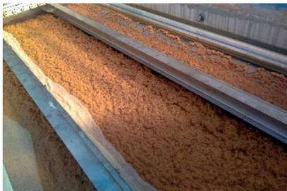
**Compacts et simples d'utilisation**, les flottateurs à air dissous EMO permettent de pré-traiter efficacement les effluents ou eaux usées industrielles, et de réduire leur charge polluante (MES, graisses, DCO, DBO<sub>5</sub>, phosphore). Ils permettent de récupérer à la fois les matières flottées et de produire des boues à forte teneur en matière sèche.
