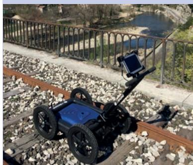
Unique Radar de Sol tri-fréquences dédié à la détection de tous types de réseaux
