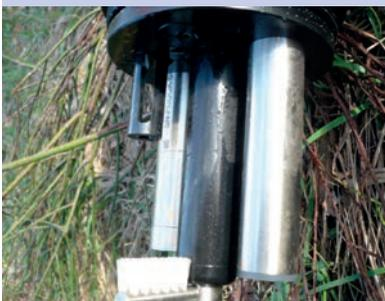
La Sambat de nke instrumentation est une sonde autonome multiparamètres à balai et télétransmission des données.
