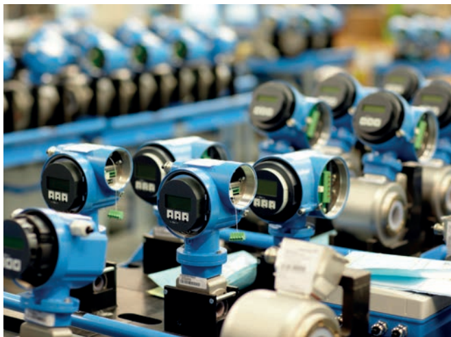
Les débitmètres électromagnétiques d'Endress+Hauser, qui intègrent des technologies avancées telles que la Heartbeat Technology, prennent en charge divers protocoles de communication, y compris EtherNet/IP et PROFINET, qui rendent l'information facilement accessible.
