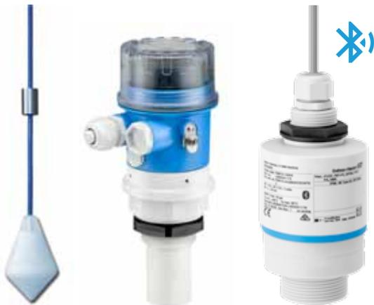
Ces mesures permettent d'observer la variation du volume stocké. La mesure de hauteur d'eau est réalisée par capteur de pression hydrostatique (voir page 3), par transmetteur ultrasons ou radar à émission libre et est complétée par une poire de niveau ACS pour la détection de niveau haut.
