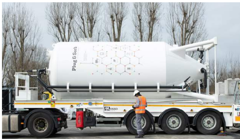
Traitement sur site de plusieurs milliers de m 3 d'eau d'extinction d'incendie contenant des émulseurs fluorés stockés dans un bassin : prétraitement + traitement par charbon actif (solution Plug & Sorb© de filtration mobile par charbon actif, par SARPI ThinkTech).
