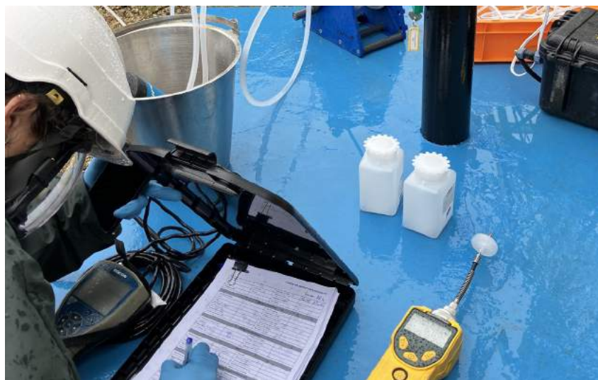
Ramboll - Prélèvements d'eau souterraine pour analyse des PFAS : une attention particulière doit être portée aux équipements et vêtements utilisés (notamment vêtements de pluie).
