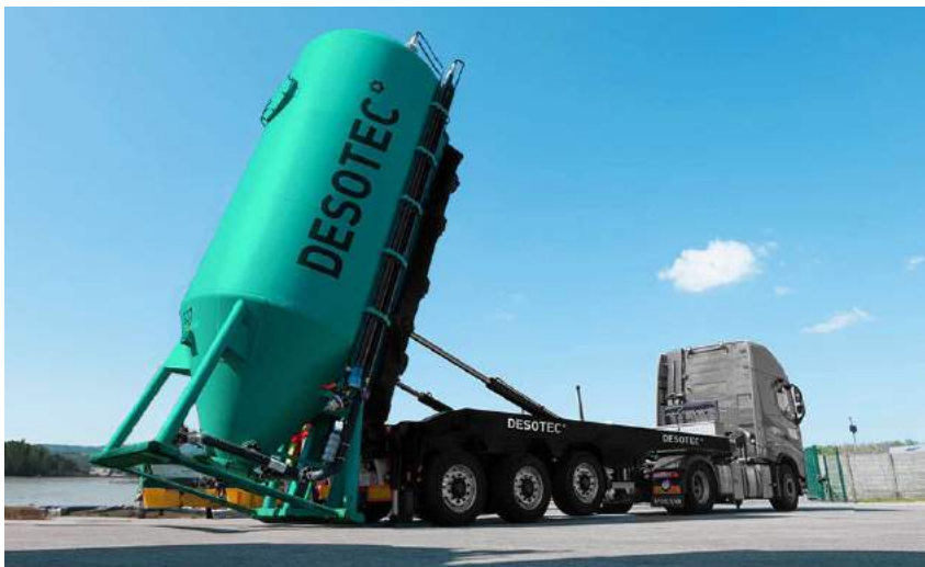
La société DESOTEC fournit des filtres mobiles, évitant ainsi la manipulation des polluants sur site. Le filtre saturé est traité hors site.
