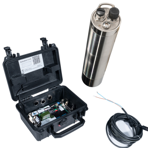
Le GS1440 de Hach est un capteur micro-électrochimique adapté aux applications d'eaux usées. Les plages de mesure sont de 0 à 5 mg/L (en phase liquide) et de 0 à 1000 ppm (en phase gazeuse). Le capteur pourra être alimenté par batteries pour s'adapter aux applications réseaux, mais peut également être connecté sur les transmetteurs SC standards de Hach pour une application en STEP.
